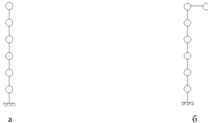
Рис. 1. Расчетная схема сооружения: а – расчетная схема здания без ДГК; б - расчетная схема здания с ДГК
