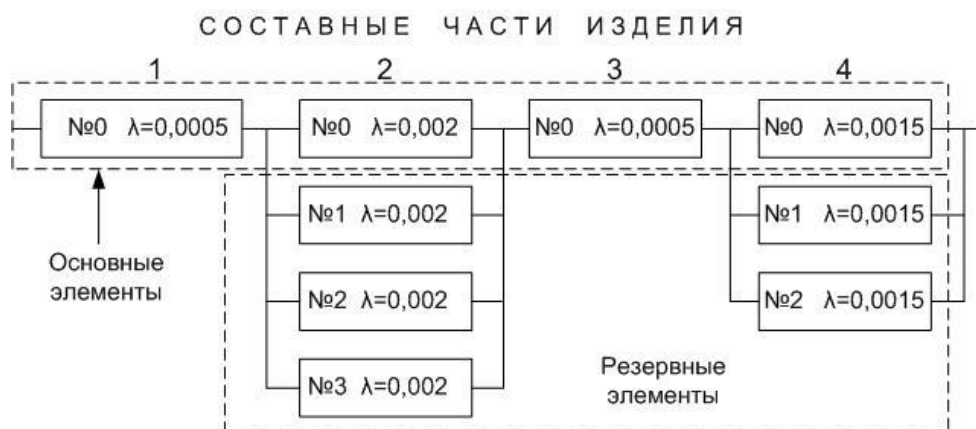
Рис. 6.1. Структурная схема изделия с резервированием
