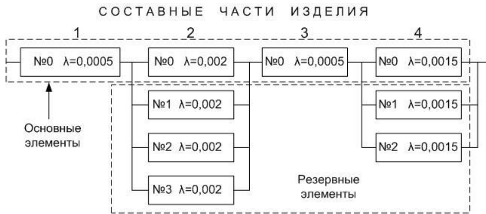
Рис. 6.1. Структурная схема изделия с резервированием
