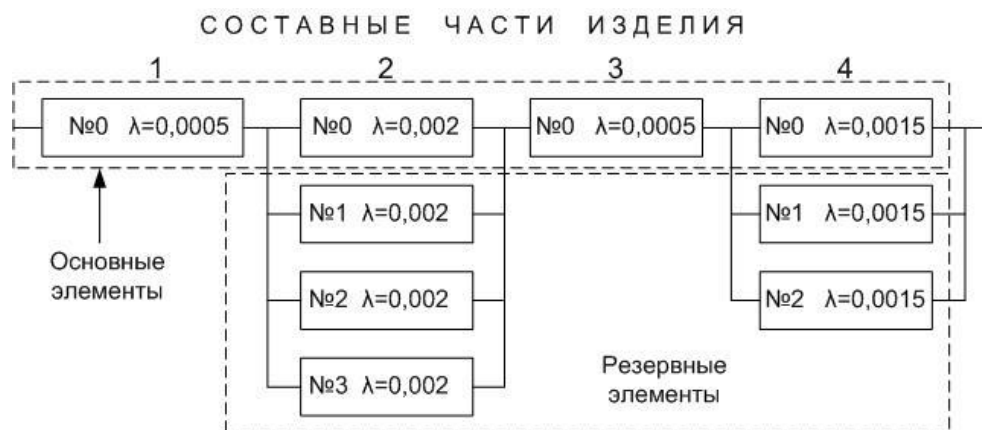
Рис. 6.1. Структурная схема изделия с резервированием
