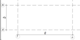
$S_{\text{срез}} = (a+2*10)*(b+2*10)$                                                                                                                                                                  | м <sup>2</sup> |        | При наличии исходных данных о границах землеотвода, площадь вертикальной планировки совпадает с площадью участка строительства |
