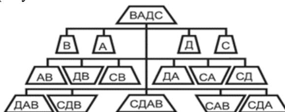
а) Укрупненная структура взаимодействия комплекса ВАДС и системы ДУ-ТП (дорожные условия – транспортный поток)
