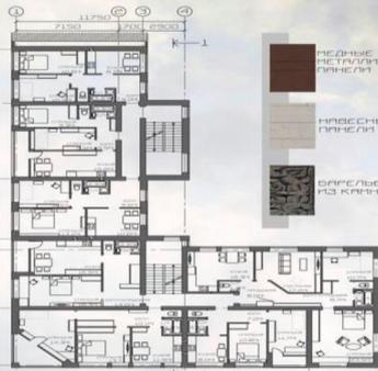
ПЛАН ТИПОВОГО ЭТАЖА М 1:150
